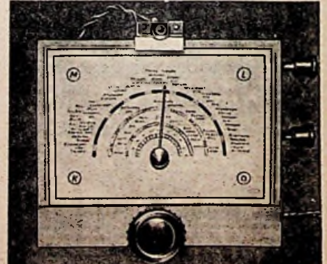
Abb. 5. Vorderansicht des Empfängerchassis mit Skala und aufsteckbarem Beleuchtungslämpchen. Die Bedienungsknöpfe des Wellenschalters und des Rückkopplungskondensators ragen rechts heraus
